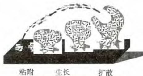
图 1 生物膜在反渗透膜表面形成过程
