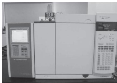
图2 无溶剂高效萃取仪同气相色谱仪联用实物图
